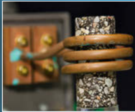
Eine Spule erzeugt ein Magnetfeld um die Probe.
