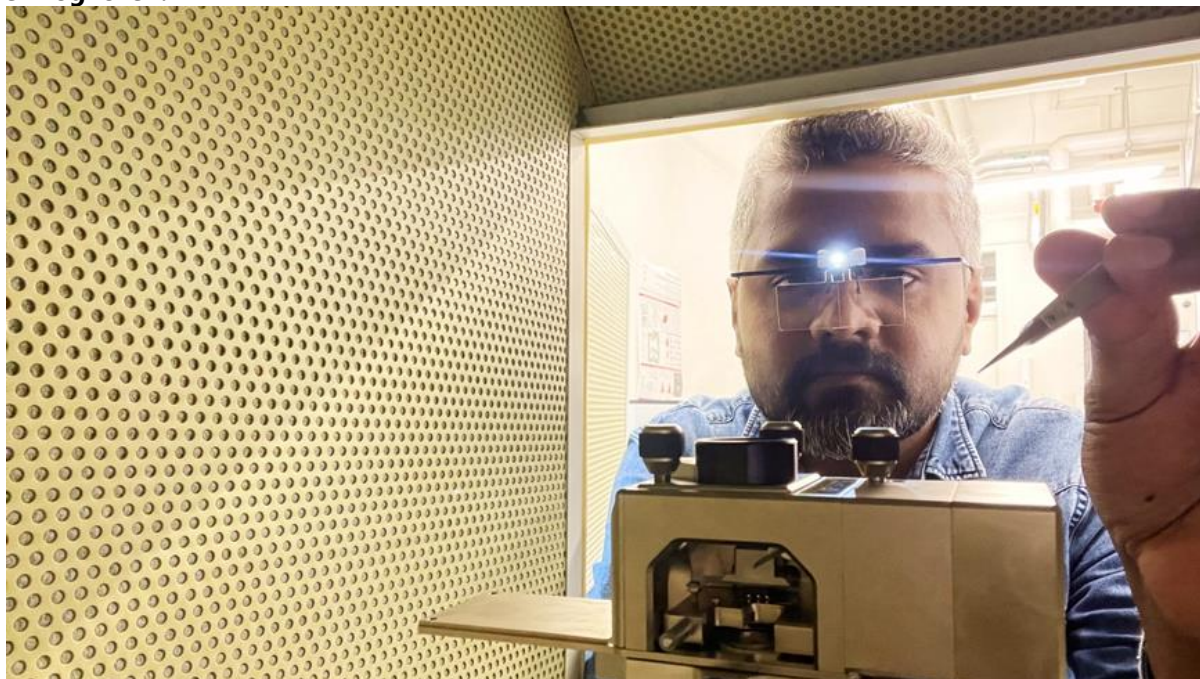
Empa-Forscher Peter Nirmalraj untersucht Blutproben mittels Rasterkraftmikroskopie (AFM). Bild: Empa
