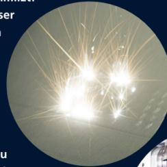
Hören, wie es erstarrt: Direct Laser Melting (DLM) ist ein lärmiges Geschäft. Die Empa lauscht der Kakophonie und kann heraushören, wann ein Materialfehler entsteht. Sofort werden Laserleistung und Druckgeschwindigkeit angepasst.
